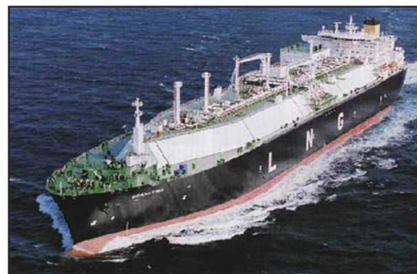
s.s. Granatina – a membrane type LNG ship
